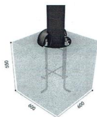
Schemat instalacji urządzenia na nodze
